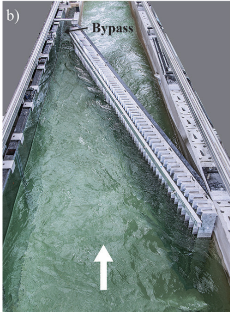
Kuva 7. Periaatekuvat a) louver, angled bar rack, modified angled bar rack b) pystysuuntainen ( \beta -malli) louver, c) kuva sivusta (ETHzürich 2017)
