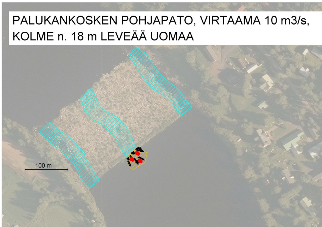
Kuva 7. Hahmotelmia eri virtaamilla aikaansaataavista koskiuomista sekä niiden edustan nivoista. Nivaesimerkit on piirretty kuviin todellista tarvetta laajemmiksi
