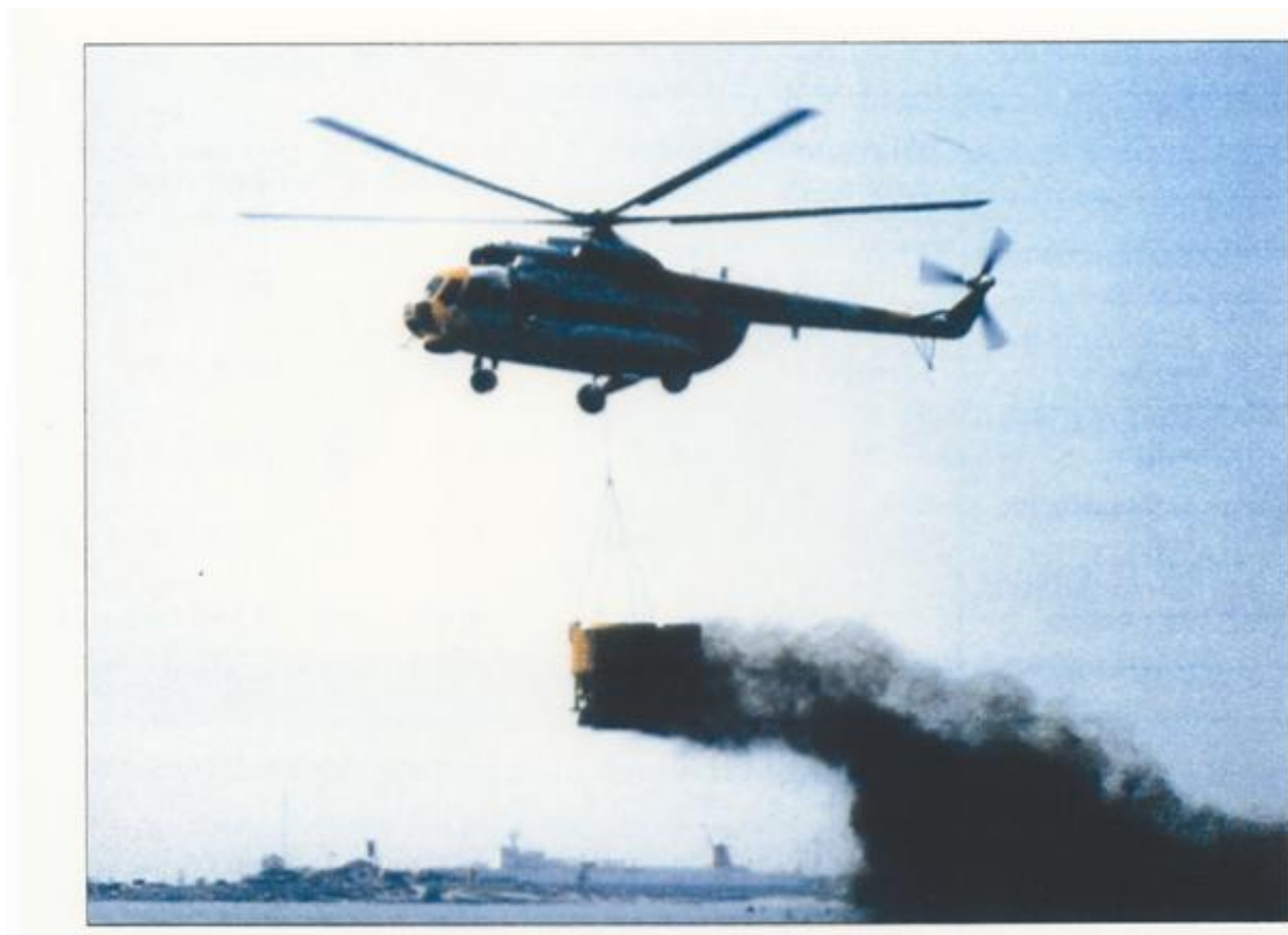
Kuva 24. Heikosti maatunutta, lämpökäsiteltyä turvetta käytetään öljyntorjuntaturpeena vesialueilla. Kuva Jyväskylästä. Kuva: K.Virtanen
