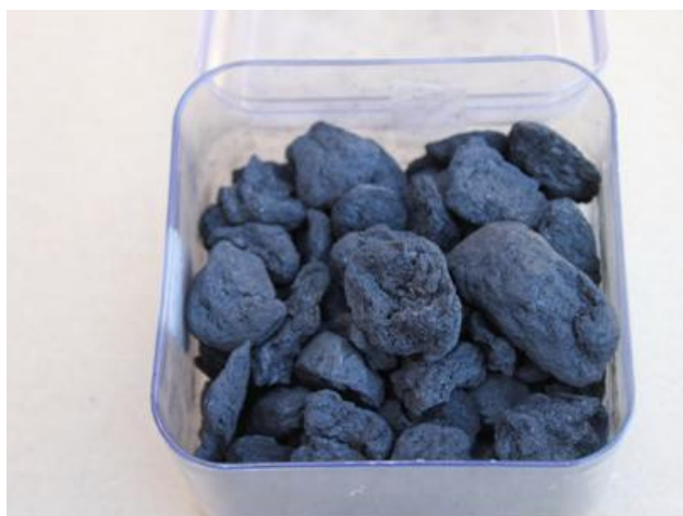
Kuva 20. Metallurgista turvekoksia, jota valmistettiin 1970-luvun lopulla Peräseinäjoella. Kuva: A. Luukkanen.
