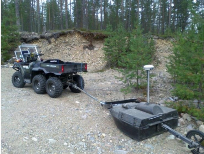
Kuva 9. GTK:n maatutkaluotauslaitteisto. Kuva: Juho Kupila, GTK.
