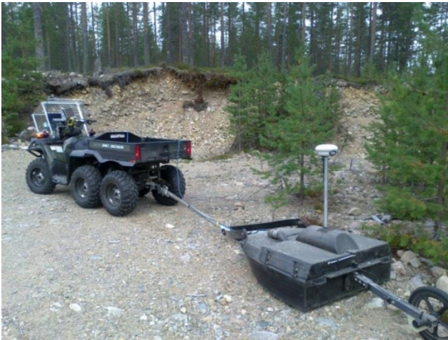
Kuva 9. GTK:n maatutkaluotauslaitteisto. Kuva: Juho Kupila, GTK.
